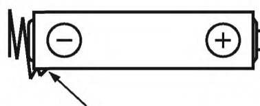
Рисунок В.10б – Оболочка батареи проколота
