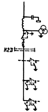
б. ВЛ от шин К2Д, шинные аппараты TV1Д и переключки от шин К1Д. ДРУ по схемам № 330-16,17
