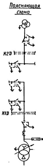
б. Трансформатор Т2. ОРУ по схеме N 330-17
