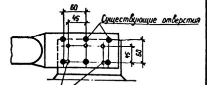
Пересверленные отверстия ф 14 (см. указания 4)
