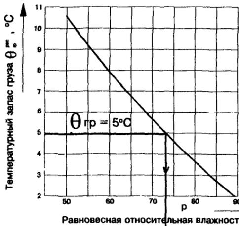
Диаграмма для определения равновесной относительной влажности воздуха и расчетного температурного запаса груза
