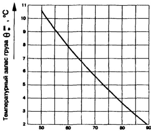
Диаграмма для определения равновесной относительной влажности воздуха и расчетного температурного запаса груза
