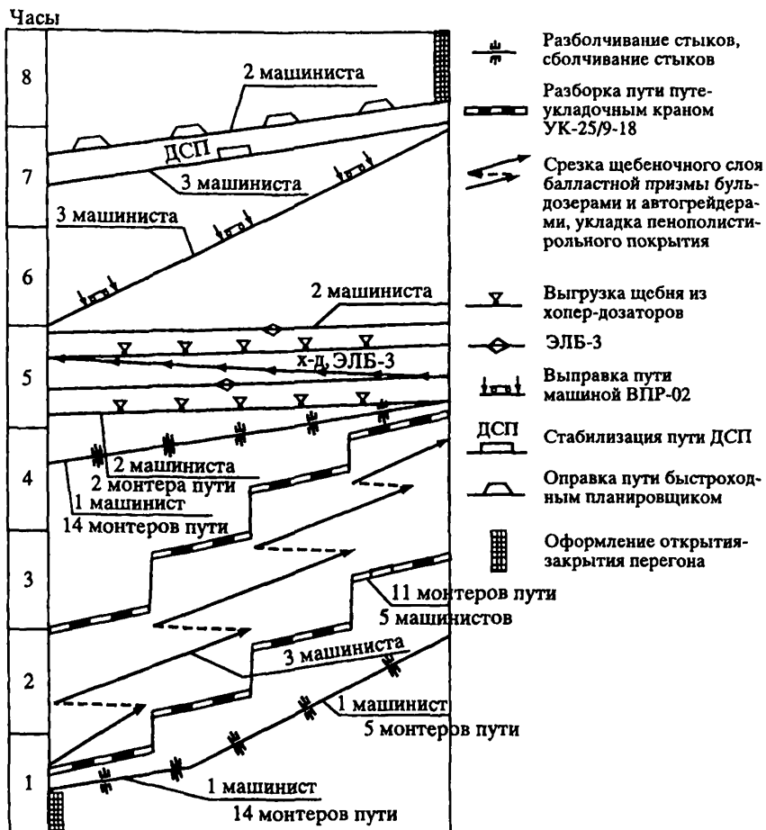
Рис. 6.3. График производства основных работ в "окно" по укладке пенополистирольного покрытия при усиленном капитальном ремонте пути (фронт работ – 600 м пути)
