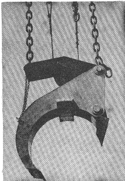
Рис. 1120.10. Крановый автоматический захват "Креветка" конструкции Белгород-Днестровского порта
