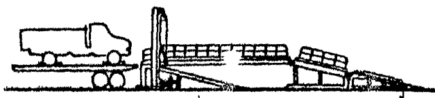
Рис. П2.2. Стационарные гидравлические аппараты для выгрузки (погрузки) колесной техники с железнодорожных платформ: а — односторонний аппарат; б — двухъярусный аппарат; в — универсальный аппарат
