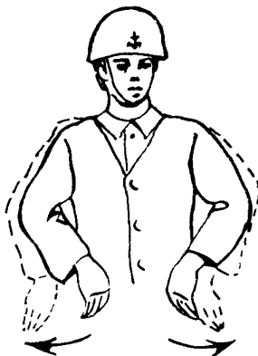
Рис. 9. Обе руки полусогнуты в локтях, опущены вниз, ладонями наружу. Обеими руками производить движения наружу
