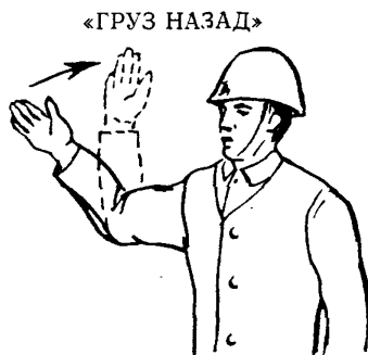
Рис. 7, 8. Правая рука полусогнута в локте перед собой, ладонью в сторону движения груза. Рукой до локтя производить движения в сторону необходимого перемещения груза
