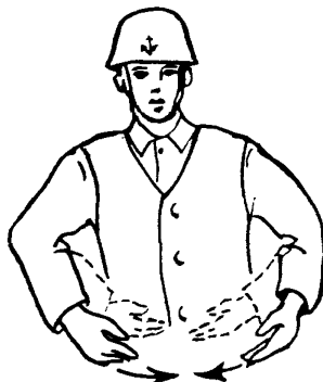
Рис. 10. Обе руки полусогнуты в локтях, опущены вниз, ладонями внутрь. Обеими руками производить движение внутрь
