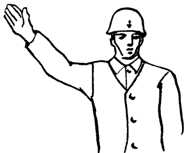
Рис. 1. Руку быстро под- нять вверх с наклоном вперед, ладонью в сторону крановщика, лебедчика
