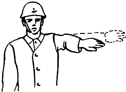
Рис. 5, 6. Рука правая или левая в горизонтальном положении, полусогнута в локте, ладонью наружу. Рукой до локтя производить движения в сторону перемещения груза
