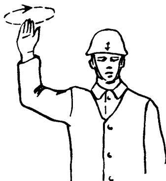
Рис. 2. Правая рука под- нята вверх, полусогнута, плечо горизонтально, предплечье в вертикаль- ном положении: «Под- нять медленно» — кисть руки вращать по часовой стрелке; «Поднять быст- ро» — рукой до локтя вра- щать по часовой стрелке
