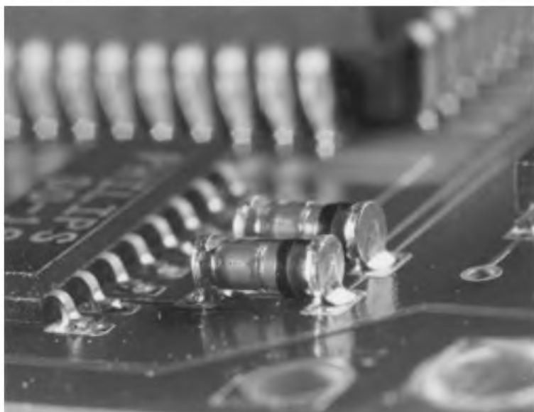
Рисунок 27 — Установка компонента с цилиндрическими чашечными контактами: заданное состояние
