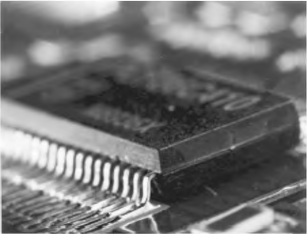
Рисунок А.1 — Галтель припоя: заданное состояние
