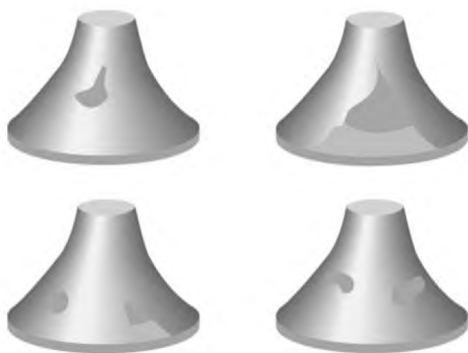
Рисунок 68 — Раковины и проколы в припое: допустимое состояние
