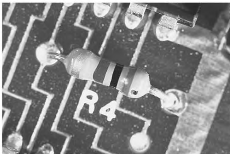
Рисунок 46 — Повреждение корпуса компонента с осевыми выводами: допустимое состояние
