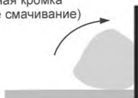
Рисунок 56 — Плохое смачивание припоя: недопустимое состояние
