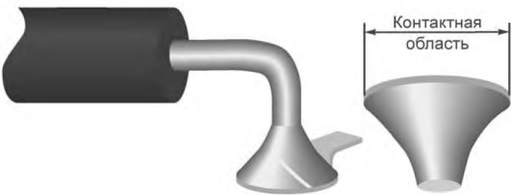
Рисунок 65 — Галтель припоя: заданное состояние
