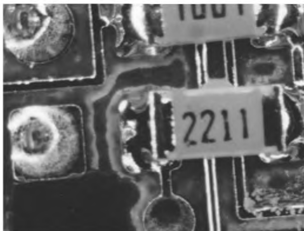
Рисунок 86 — Внедренные в печатную плату остатки: недопустимое состояние
