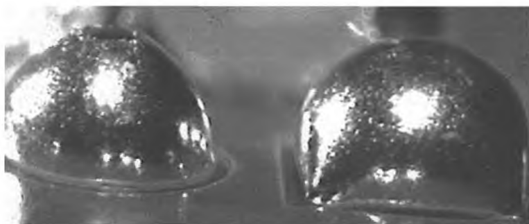
Рисунок 67 — Галтель припоя: недопустимое состояние
