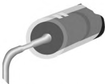
Рисунок 44 — Повреждение осевого вывода компонента: допустимое состояние
