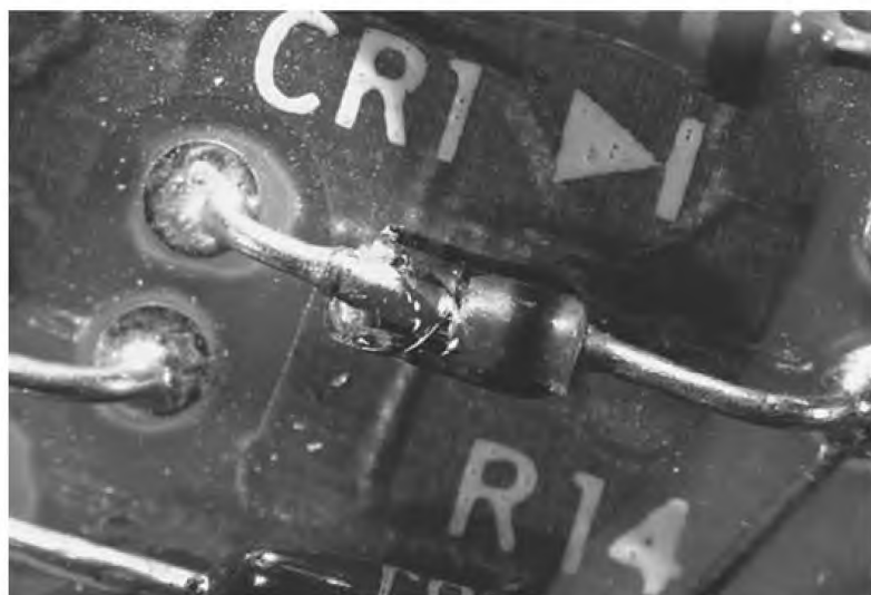
Рисунок 48 — Повреждение стеклянного корпуса компонента с осевыми выводами: недопустимое состояние
