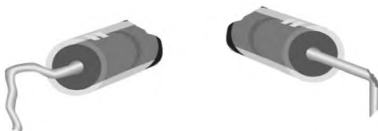
Рисунок 45 — Повреждение осевого вывода компонента: недопустимое состояние
