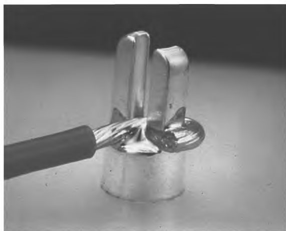
Рисунок 34 — Паяное соединение провода с контактом: допустимое состояние
