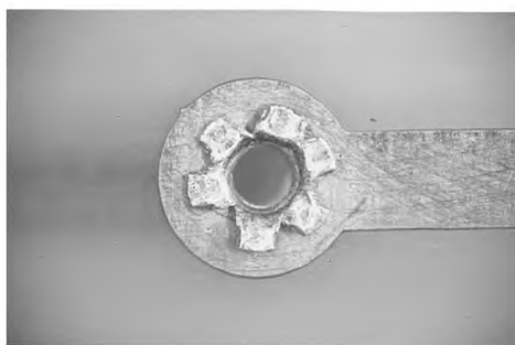
Рисунок 1 — Разрывы фланца с раструбом: виды состояний
