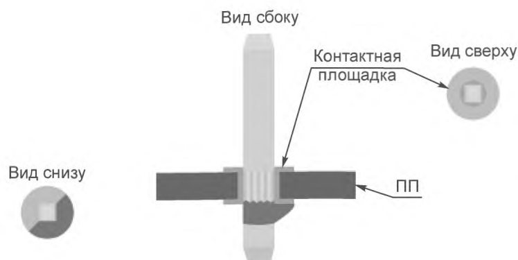
Рисунок 19 — Галтели припоя: допустимое состояние
