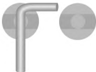
Рисунок 7 — Боковое соединение разводки, вилкообразный контакт — недопустимое состояние
