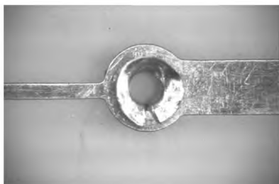
Рисунок 2 — Установка фланца с раструбом в металлизированное отверстие: виды состояний
