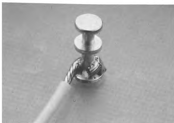
Рисунок 36 — Паяное соединение провода с контактом: недопустимое состояние
