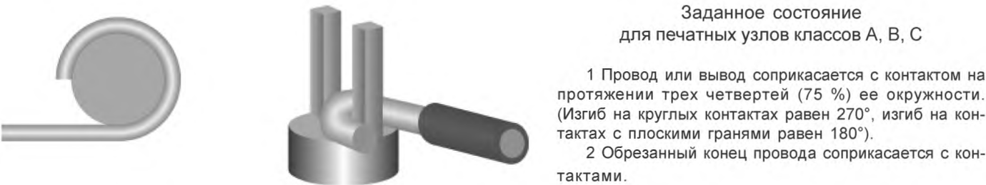
Рисунок 5 — Боковое соединение разводки, вилкообразный контакт: заданное состояние
