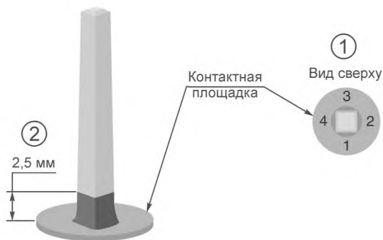
Рисунок 21 — Состояния подъема припоя: виды состояний
