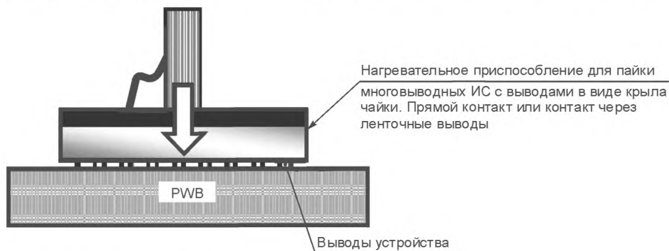
Рисунок 9 — Пайка оплавлением нагретыми термодами
