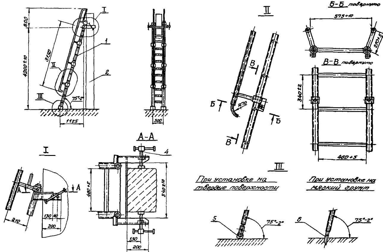
I - лестница; 2 - колонна железобетонная; 3 - ограждение перильное; 4 - винт пружинной; 5 - бампер резиновый; 6 - упор нижний
