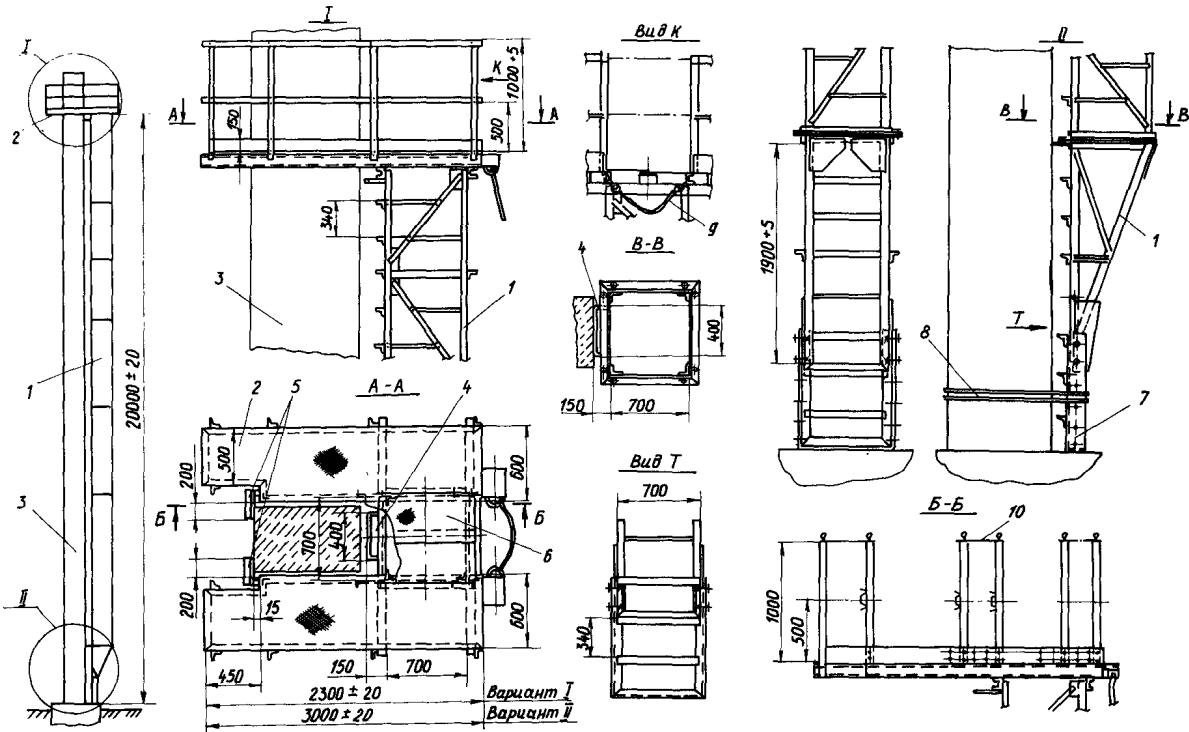
1 - секция лестницы; 2 - рабочая площадка; 3 - колонна; 4 - упор; 5 - фиксаторы; 6 - лиж откидной; 7 - переставной элемент; 8 - скрутка из проволоки; 9 - строп; 10 - съемное ограждение (переставное)
