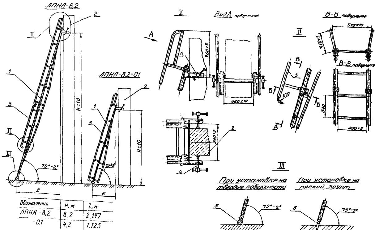
1 - лестница; 2 - колонна железобетонная; 3 - ограждение переднее; 4 - винт пружинной; 5 - самокрезиновый; 6 - упор нижний
