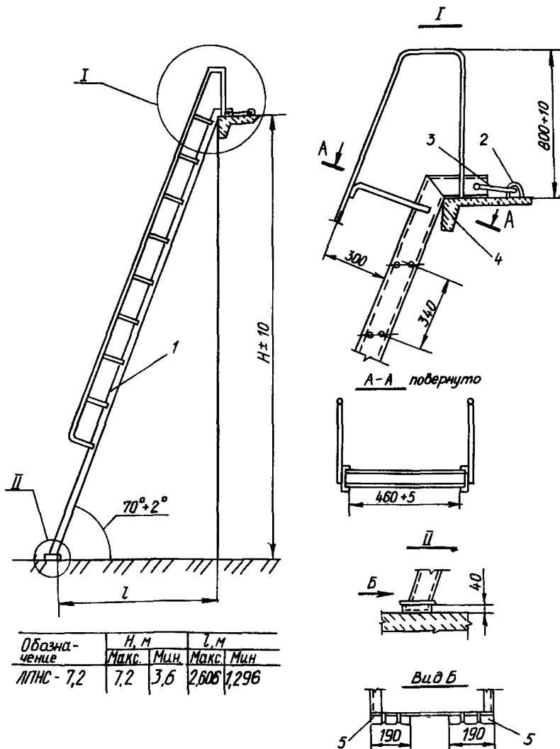
I - лестница; 2 - петля плиты монтажной; 3 - скрутка из проволоки; 4 - плита железобетонная; 5 - башмак резиновый
