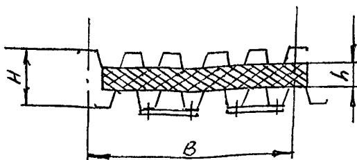
$h$  — толщина утеплителя $l$  — размер уточняется по спецификации заказчика
