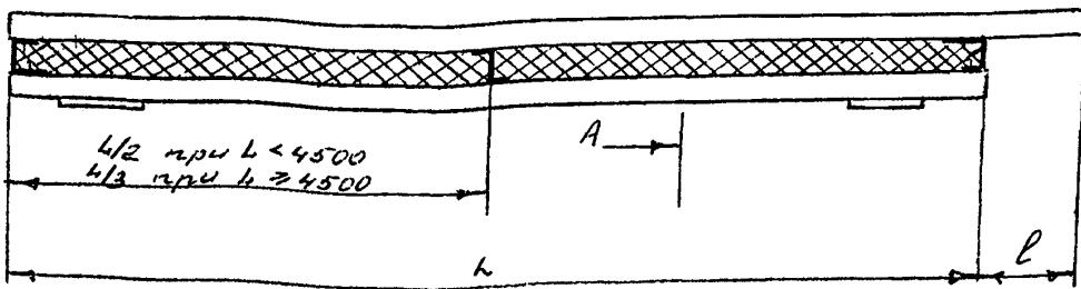
A - A
