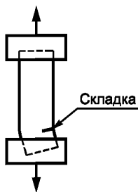
Рисунок 5 — Пример образования складок у образца из-за скручивания
