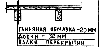
ДЕТАЛЬ ПЕРЕКРЫТИЯ НАД НАВЕСОМ
