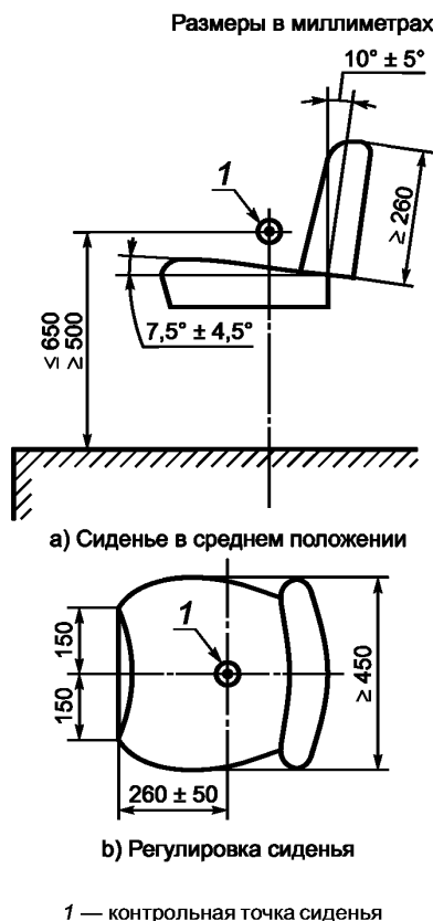
Рисунок 2 — Размеры сиденья оператора
