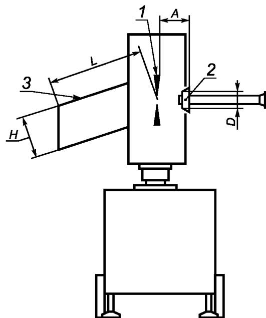
1 — механизм скрепления; 2 — тормоз оболочки; 3 — защитное ограждение
