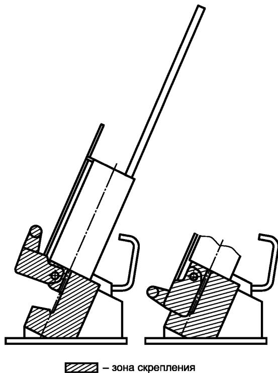
Рисунок 6 — Клипсатор с подвижной направляющей клипс. Опасные зоны
