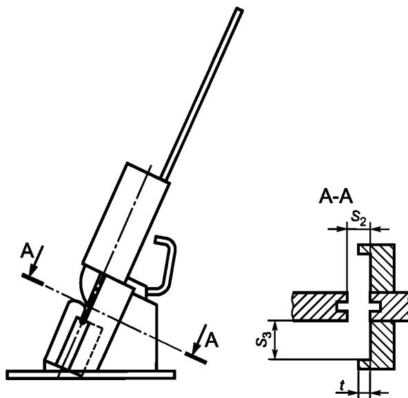
$S_2 > 8 \text{ мм}; S_3 \leq 15 \text{ мм}; S_2 - t \leq 8 \text{ мм}$
