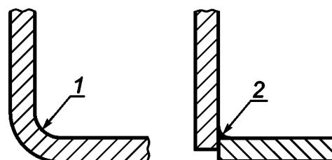
1 — радиус, получаемый при машинной обработке изогнутым лезвием, равный не менее 3,2 мм;
