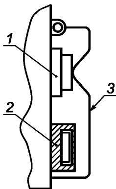
1 — переключатель «ВЫКЛ.»; 2 — переключатель «ВКЛ.»; 3 — защитный кожух
