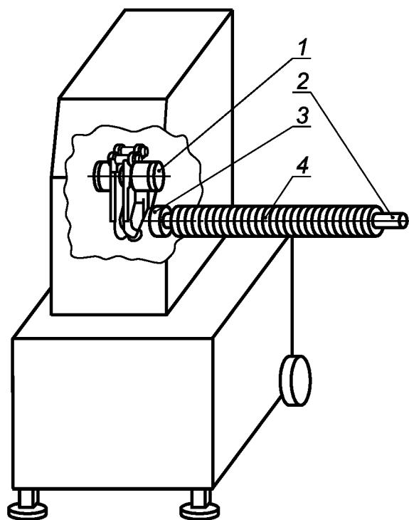
1 — устройство расширения-пережима; 2 — цевка; 3 — тормоз оболочки; 4 — оболочка
