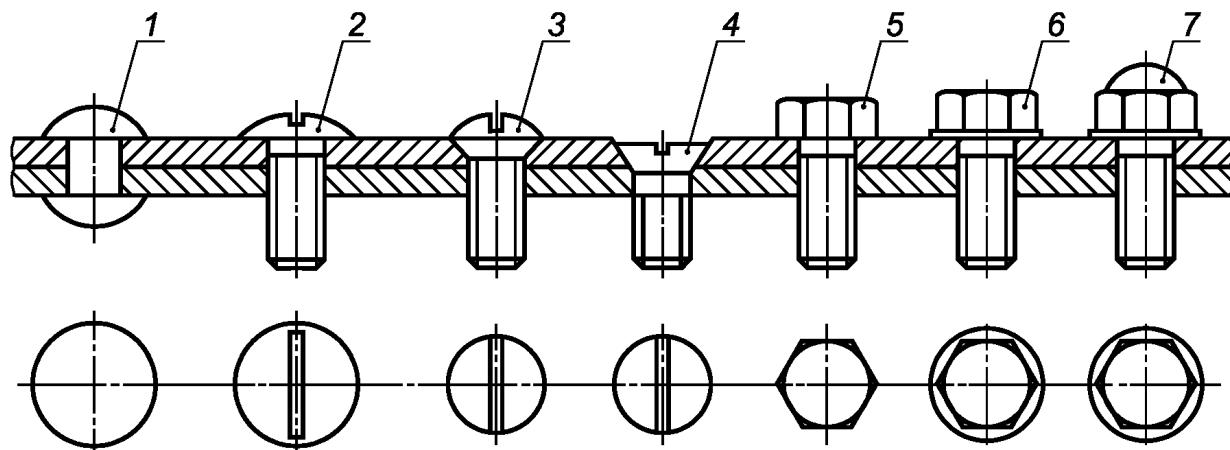
1 — круглая головка; 2 — овальная головка; 3 — полупотайная головка; 4 — потайная головка; 5 — шестигранная головка;
