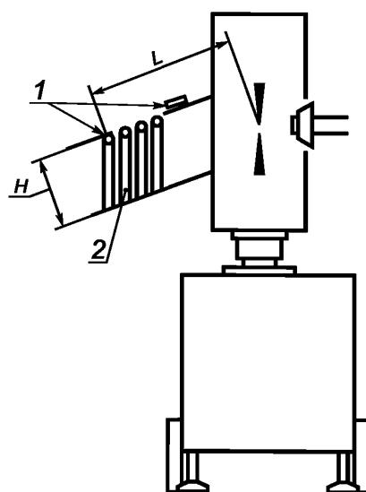
1 — защитное ограждение или световой барьер; 2 — защитное ограждение
