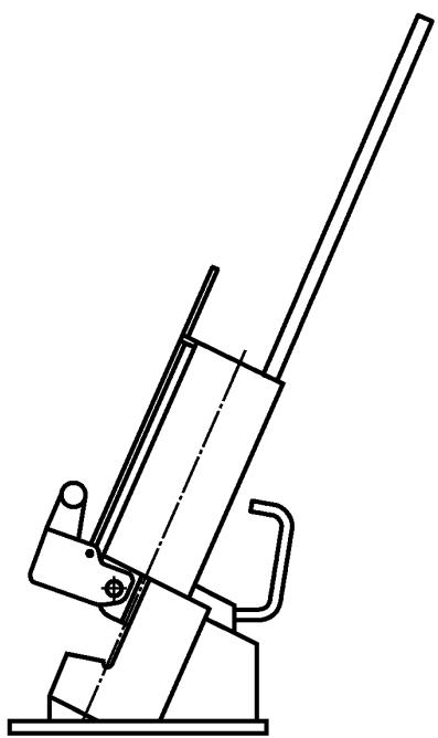
Рисунок 11 — Клипсатор с подвижной направляющей клипс. Устройство пережима открыто
