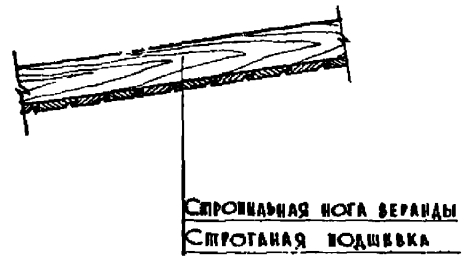
ВАРИАНТ ПОДШИВКИ ПОМОЩКА ВЕРАНДЫ СТРОГАНЫМИ ДОСКАМИ
