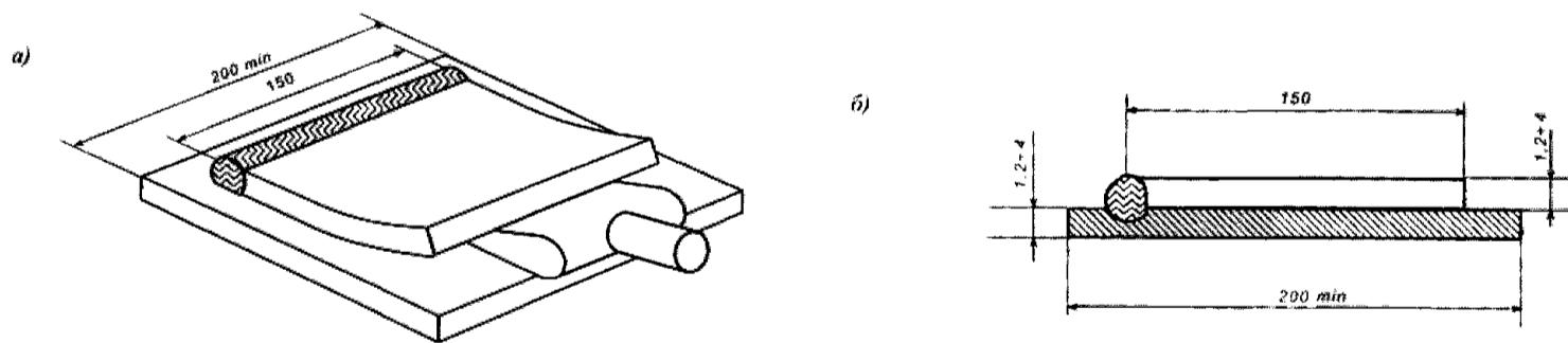
Рис. 2 Нахлесточная проба, испытываемая на разъединение пластин:
