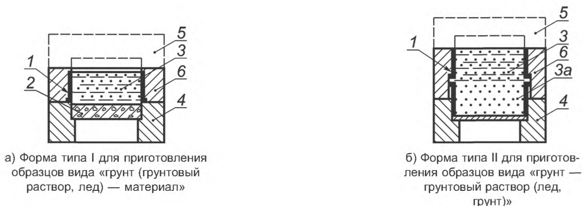
1 — рабочее кольцо срезного прибора; 2 — материал; 3 — грунт (лед, грунтовый раствор); 3а — грунт; 4 — опорное кольцо; 5 — крышка формы; 6 — защитное кольцо формы
