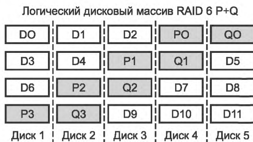
Рисунок А.7 — Структура размещения блоков данных (D) и блоков проверки (P и Q) в системе RAID 6
