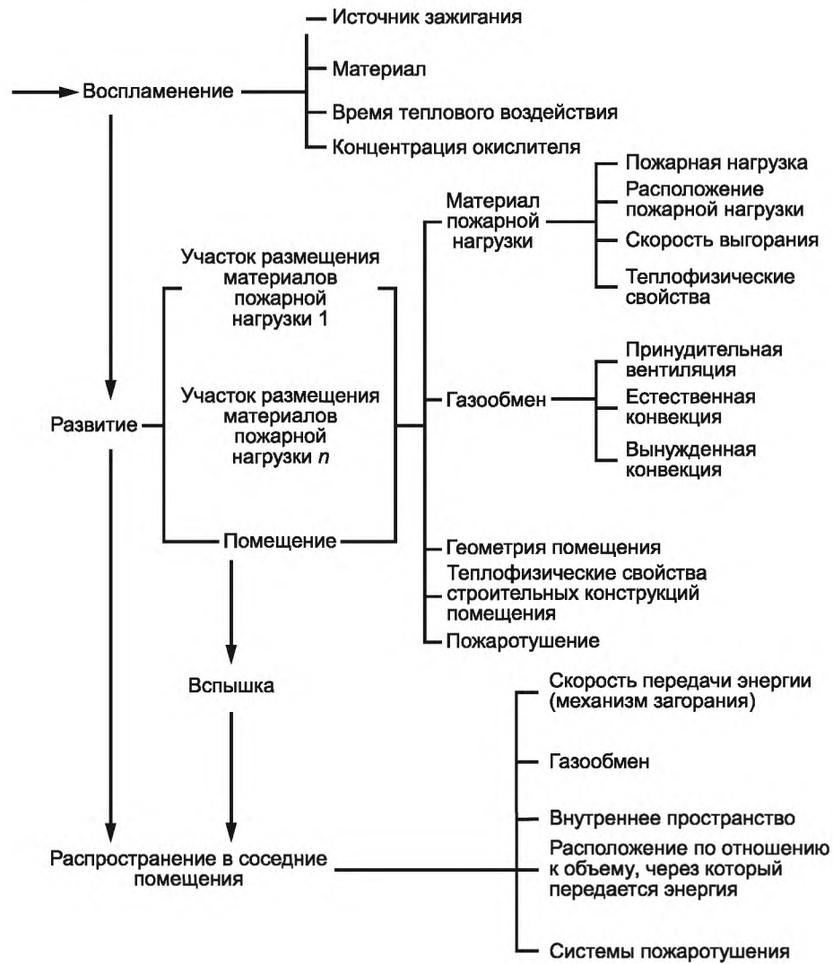
Рисунок 1 — Факторы, влияющие на возникновение, развитие и распространение пожара в здании
