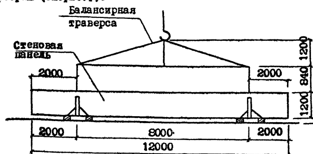
Рис.1. Строповка стеновой панели при разгрузке и монтаже.
