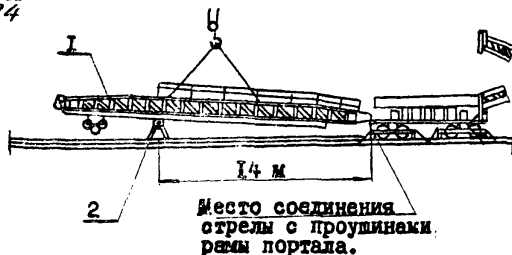
Рис. 8 Схема присоединения стрелы к ходовой части крана.
