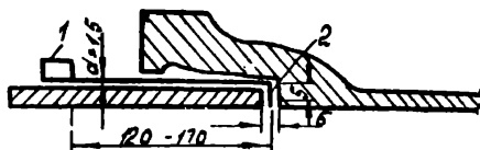
Рис. 5. Проволочный крючок для замера величины зазора между торцами стыкуемых труб
