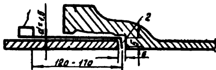
Рис.5.Проволочный кличок для замера величины зазора между торцами стыкуемых труб
