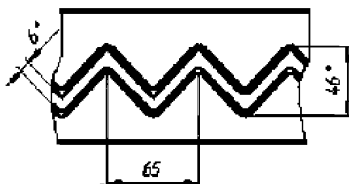
Рис. 5.2 Зигообразная выштамповка на вертикальных стенках
