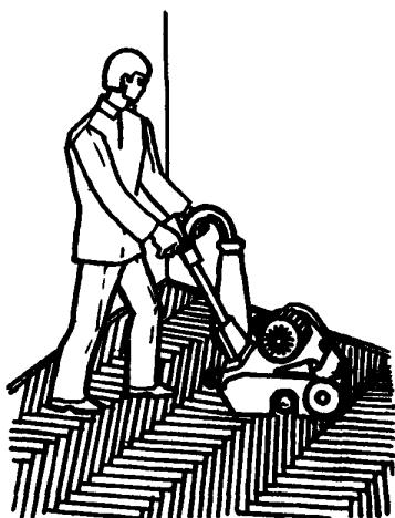
Паркетчики шлифуют поверхность пола при помощи паркетошлифовальных машин. Машины подключают к электросети при поднятом барабане. Медленно опуская барабан с помощью рычага, вводят машину в работу, при этом вращающийся барабан прижимается к обрабатываемой поверхности. После ввода машины в работу не следует оставлять ее на одном месте, т.к. возможно появление прожогов и впадин на поверхности покрытия
