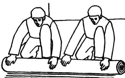
Облицовщики  $O_1$  и  $O_2$  раскатывают свернутую часть полотнища ковра и плотно прижимают его к намазанному kleem основанию. Кромки полотнища шириной 8–10 см остаются неприклеенными
