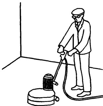
Облицовщики  $O_3$  и  $O_4$  электрополотерными машинами полируют террацевое покрытие пола, а облицовщики  $O_1$  и  $O_2$  полотерными щетками полируют места примыкания
