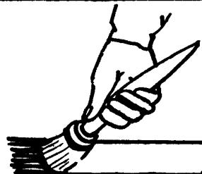
Маляры  $M_1$  и  $M_2$ , нагнувшись и слегка согнув колени, прикладывают отжатые кисти к плинтусам и плавными движениями слева направо производят отводку верхних границ плинтусов, а затем покрывают лаком весь плинтус. Кисть следует держать наклонно к плоскости плинтуса, слегка поворачивая вокруг оси
