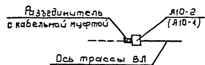
Схема установки опоры с разъединителем и кабельной муфтой на ВЛ
