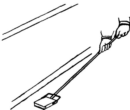
Маляр передвигает машину к месту начала шлифовки. Затем нажимает обеими руками на ручку, приподнимая при этом
