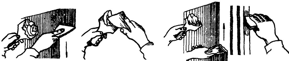
При нанесении шпаклевки маляр работает двумя шпателями. Взятую на первый шпатель порцию шпаклевки он наносит на поверхность тонким ровным слоем толщиной 2–3 мм. Излишки шпаклевки с первого шпателя маляр снимает на второй, а затем первым шпателем сглаживает поверхность, двигая его в обратном направлении. Профилированные детали он шпаклюет универсальным шпателем с резиновой вставкой
