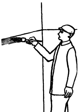
Маляр  $M_3$  погружает кисть в огрунтовочный состав, отжимает ее о стенку ведра и прикладывает к стене у отбитой линии. Движением руки слева направо он делает ниже отбитой линии отводку шириной 20–25 см. При этом маляр держит кисть наклонно к плоскости стены в направлении движения, слегка поворачивая ее вокруг оси по мере расходования огрунтовочного состава. Маляры  $M_1$  и  $M_2$  аналогичным способом делают отводку нижней части стены над плинтусом
