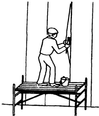
Маляр  $M_2$  отгибает кромки полотнищ вдоль стыка и промазывает их клеевым составом. Маляр  $M_1$  приклеивает кромки к стене, соединяя их впритык, и тщательно разглаживает шов шпателем. Затем оба маляра влажными губками стирают выступивший на обои клей
