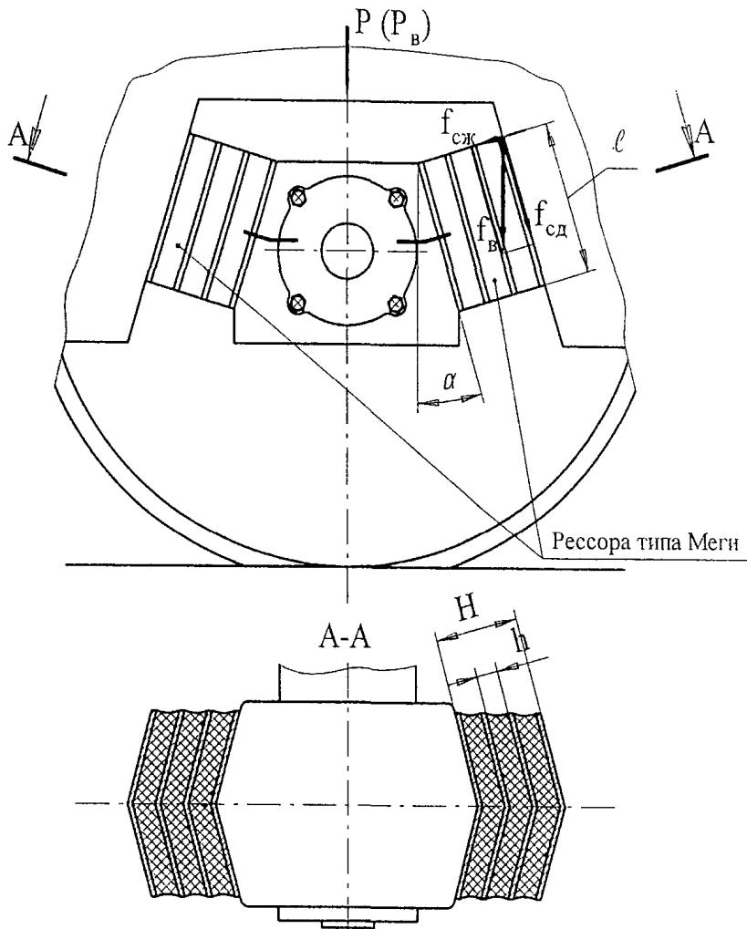
Рисунок 1 – Установка рессор типа Меги в узле соединения
