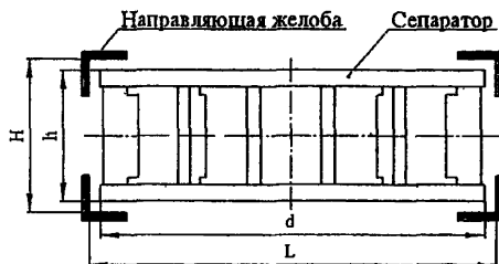
Рисунок Г.1 – Схема желоба для сбрасывания сепараторов L - d = H - h = 10^{+1} \text{ мм}
