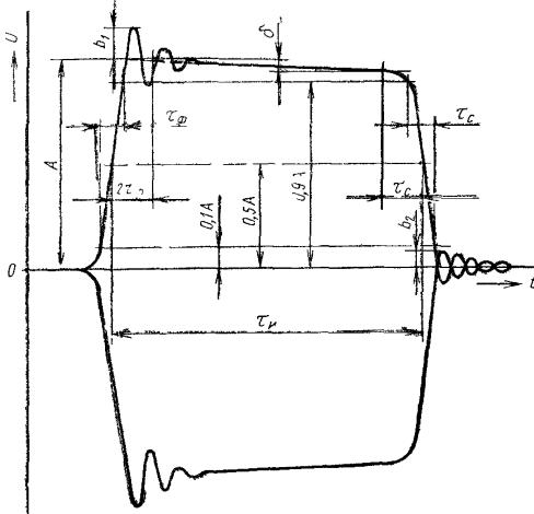
Значение  $A$  амплитуды огибающей радиоимпульса находят путем продления плоской части вершины до пересечения с фронтом импульса.
