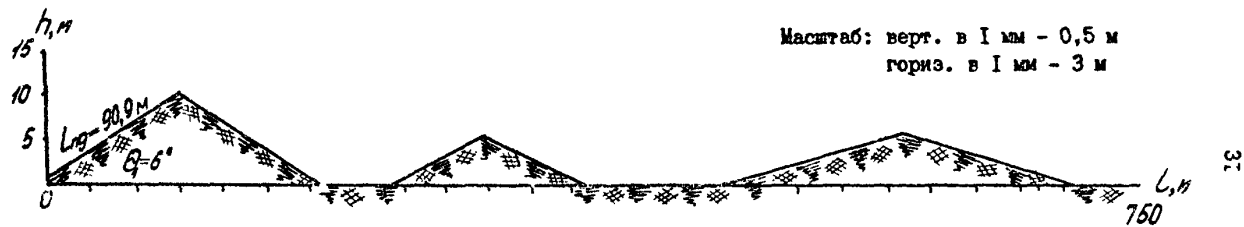
Рис. 8. Продольный профиль трассы пролегания трубопровода
