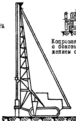
Копровая установка с хвостовым распо- ложением стрелы
