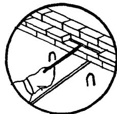
Монтажники  $M_1$  и  $M_2$  расстроповывают плиту и подают команду машинисту крана переместить строп к месту складирования плит. Затем монтажник  $M_2$  вставляет стальные анкеры в специально оставленные в кирпичной стене (бортитке) гнезда, а монтажник  $M_1$  электросваркой крепит их к монтажным петлям плит
