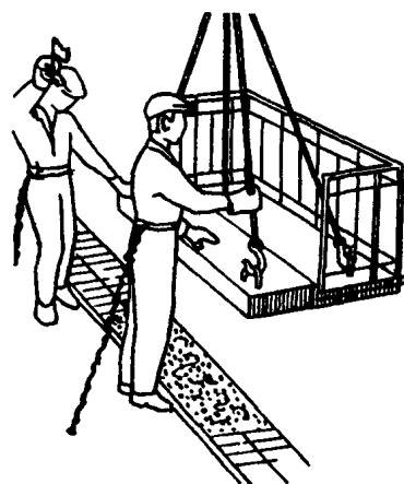
Монтажники  $M_1$  и  $M_2$  принимают плиту и направляют ее к месту укладки. Монтажник  $M_3$  подает инвентарную стойку на балкон нижележащего этажа и после укладки плиты ставит стойку под нее
