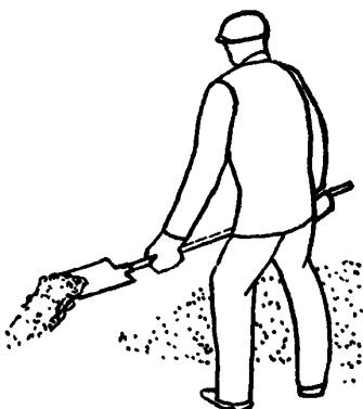
Кровельщики K<sub>2</sub> и K<sub>3</sub> рассыпают песок лопатами ровным слоем на мастику. Затем они отвезут тележки к месту их загрузки
