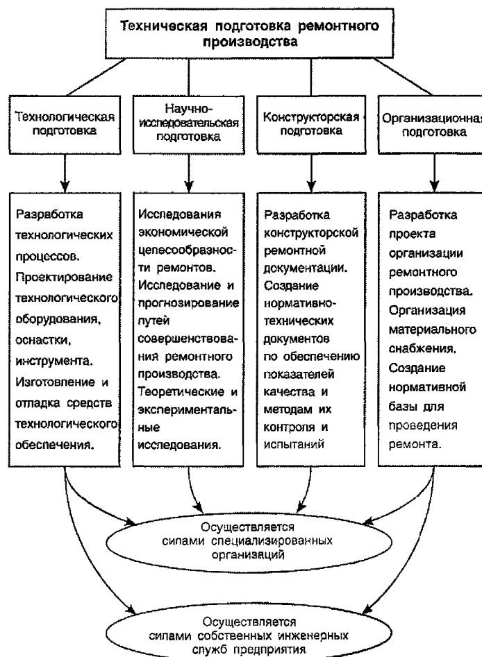
Рисунок 1 – Схема системы технической подготовки ремонтного производства арматуры
