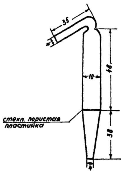
Рис. I. Стеклянная трубка с пористой пластинкой для отбора проб воздуха
