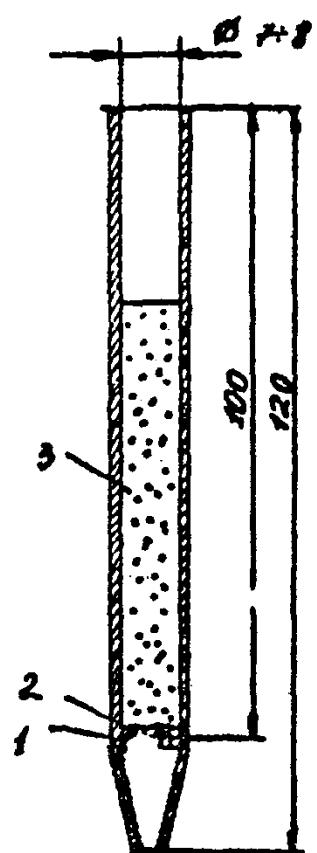
Рис.3. Концентрационная трубка
