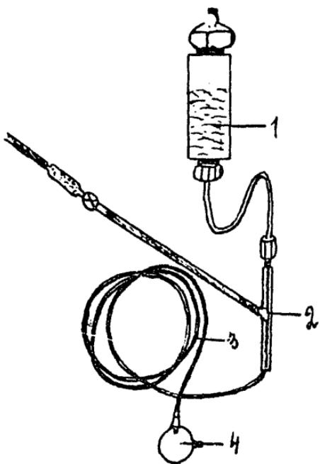
Рис. 2. Схема динамического диффузионного дозатора.
