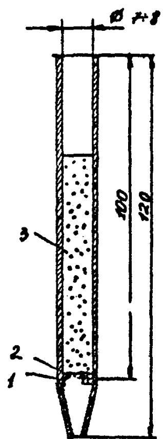
Рис.3. Концентрационная трубка
