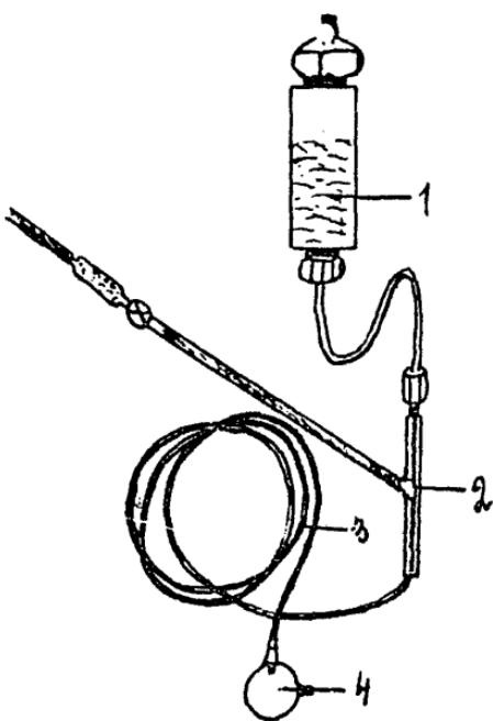
Рис. 2. Схема динамического диффузионного дозатора.
